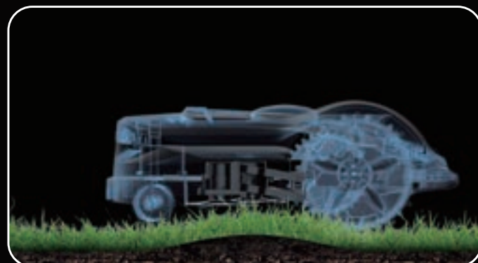
不整地対応フローティングカットシステム
