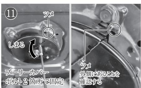
⑪ ベルトの交換が完了したら、外したプーリーカバー(部分)を取り付けます。固定側のプーリーカバーの『ツメ』が、再度取り付ける側のプーリーカバー(部分)の外側にあることを確認して、2箇所のボルト(8mm)を取り付けて元の状態に戻します。
