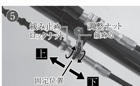
⑤次に調整ナットを緩めてワイヤー位置を調整します。上下の調整ナットを緩めてから、以下の通りに固定位置を移動し、調整してください。
