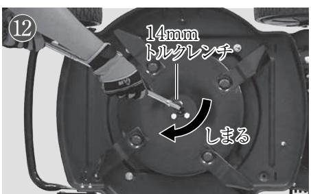
⑫ 刃刃取付部の軸についている金具の半月キー位置に合わせて、スペーサー、刃刃ディスクの順に通し、取り付けます。14mmのソケットレンチで固定ボルトを仮止めし、トルクレンチで固定ボルトを増し締めしてください。
