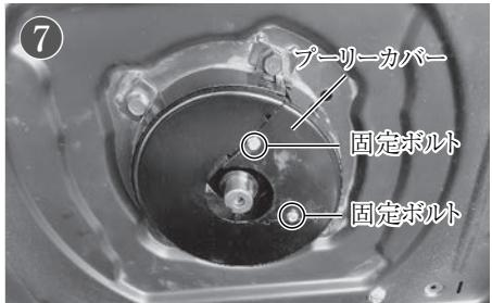
⑦ プーリーカバーにある2箇所の固定ボルトを8mmの工具を使って外します。プーリーカバーが部分的に取り外せるようになります。
