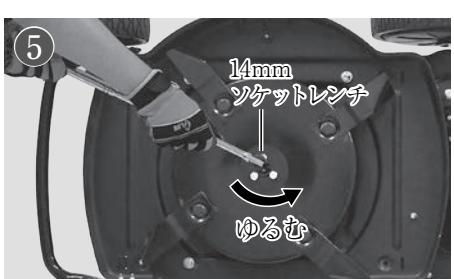
⑤刈刃ディスク中央の固定ボルトを14mmのソケットレンチで取り外します。ボルトを取り外す際に刈刃ディスクが回転しないように片手で固定しながら取り外してください。
