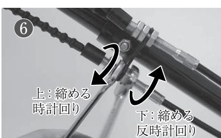
⑥調整位置が決まつたら調整ナット両側から（上の調整ナットは時計回り、下の調整ナットは反時計回り）締めて固定します。
