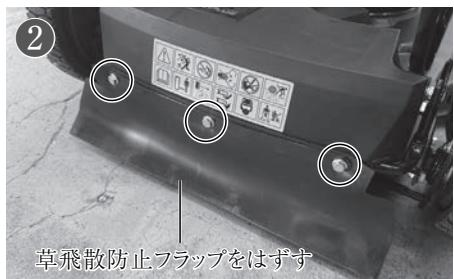
②機体背面の草飛散防止フランプを取り外します。固定している六角ボルト(3箇所)は、10mmの工具を使用して外してください。
