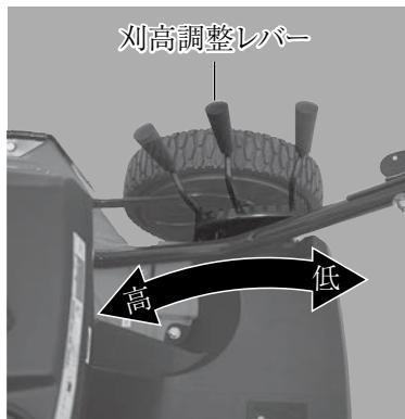
刈高の調整は 20 ~ 70 mmまでの8段階調整が可能です。高さの目安は草や土壤の条件によって異なります。切断面の高さを調整する時は必ずエンジンを停止させてください。高さの目安がわからない場合は必ず一番高い設定から段階的に下げ刈高を設定してください。
