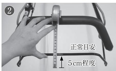
②機体をゆっくり後ろへ移動させながら、走行クラッチレバーを5cm程度握りこむと後輪がロックされる状態が正常な遊び幅になります。それより遊びが多い場合、少ない場合はワイヤーを調整します。
