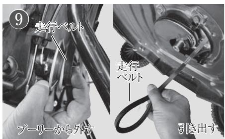
⑨ 走行ベルトを後ろ側プーリーから前側プーリーの順に外し、プーリーカバーの開口部から、取り外した走行ベルトを引き出します。
