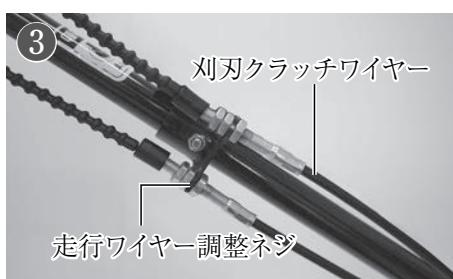
③ワイヤーを調整するには始動スイッチ付近の走行ワイヤー調整ネジで長さを調整します。
