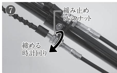
⑦緩み止めロックナットを調整ナットのところまで締めて調整は完了です。
