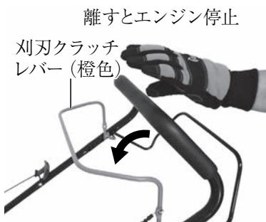
刈刃クラッチレバーから手を離すとエンジンが停止し、刈刃の回転も停止します。
