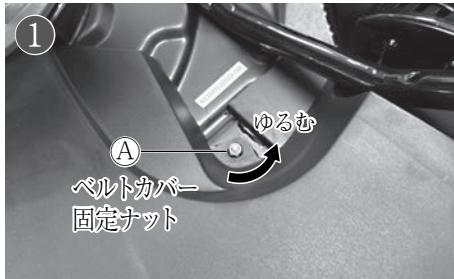
①写真のⒶの位置にあるベルトカバー固定ナットを10mmの工具を使用して取り外します。
