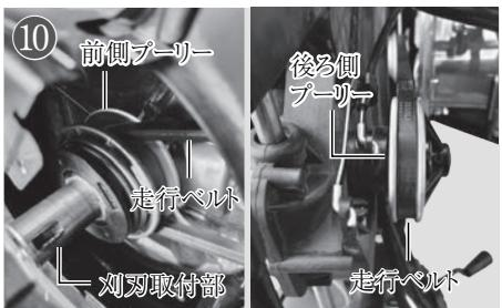
⑩ 新しい走行ベルトをプーリーカバーの開口部へ差し入れます。前側プーリーへ走行ベルトをかけ、後ろ側プーリーの順に取り付けていきます。その後、⑧で緩めたプーリーの調整ボルト(⑧)を締めてベルトを固定します。後ろ側プーリーがベルトと水平になるよう調節しながらボルトを締めてください。
