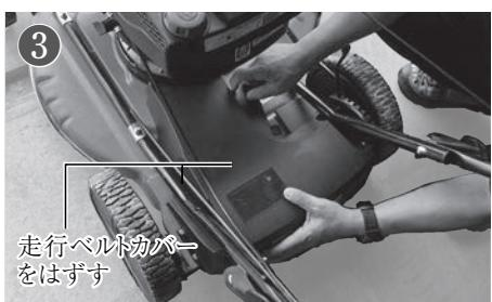
③走行ベルトカバーを上へ引き上げて外します。走行ベルトが見えるようになります。
