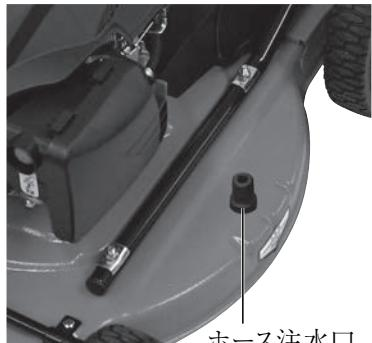
ホース注水口に水道ホースを接続し、エンジンを始動しブレードを回転させることで、ブレードとデッキ内部を洗浄することができます。草の刈り取り後の洗浄メンテナンスとしてご使用ください。
