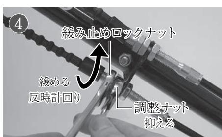
④緩み止めロックナットを緩めます。13mmレンチを2本使って、緩み止めロックナットの下にある調整ナットを抑えながら、上の緩み止めロックナットを緩めると緩めやすいです。
