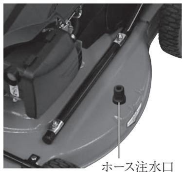
ホース注水口に水道ホースを接続し、エンジンを始動しブレードを回転させることで、ブレードとデッキ内部を洗浄することができます。草の刈り取り後の洗浄メンテナンスとしてご使用ください。
