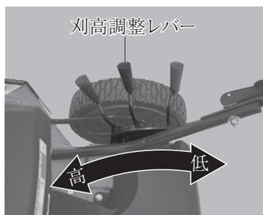
刈高の調整は24～80mmまでの8段階（8mmずつの変換）調整が可能です。高さの目安は草や土壌の条件によって異なります。切断面の高さを調整する時は必ずエンジンを停止させてください。高さの目安がわからない場合は必ず一番高い設定から段階的に下げ刈高を設定してください。
