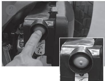
② 始動ポンプ中央の突起にある空気口を塞ぎながら、2～3回しっかりと押し込みます。
