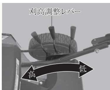
刈高の調整は 24 ~ 80 mmまでの8段階 (8mmずつの変換) 調整が可能です。高さの目安は草や土壤の条件によって異なります。切断面の高さを調整する時は必ずエンジンを停止させてください。高さの目安がわからない場合は必ず一番高い設定から段階的に下げ刈高を設定してください。
