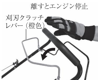
刃刃クラッチレバーから手を離すとエンジンが停止し、刃刃の回転も停止します。
