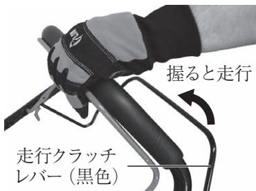
刈刃クラッチレバーを握ったまま走行クラッチレバーを握る事で自走します。早歩き程度の速度で走行しますが、ゆっくり作業されたい場合は走行クラッチレバーを放し手押しで任意の歩行速度での作業をお勧め致します。
