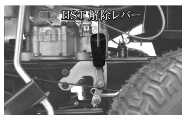
HST 解除をするときは、HST 解除レバーを横に倒します。HST 解除により車輪が動きます。
