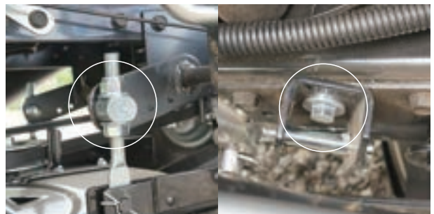
シフトリンク(走行操作レバーを操作した時の可動部)
