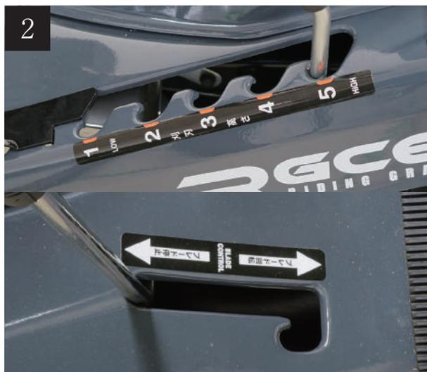
道路を横切る時は、一番高く(5段)し、刈刃回転制御レバーを「ブレード停止」にします。
