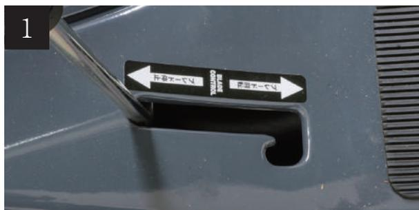
エンジンを掛けるときは、刈刃クラッチレバーが「ブレード停止」の矢印先端の位置に合わせます。
