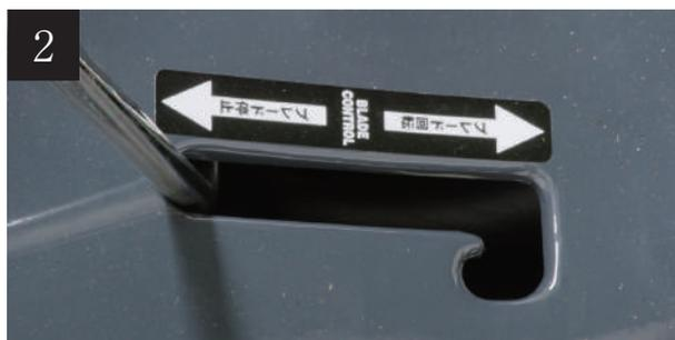
移動をする際は、必ず刈高調整レバーの一番高く（6段）し、刈刃回転制御レバーを「ブレード停止」にしてください。
