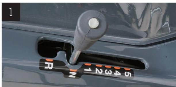
1 前進する場合は、走行操作レバーを希望するスピードの位置「1～5」に合わせます。後進する場合は、走行変速レバーを「R」に合わせます。
