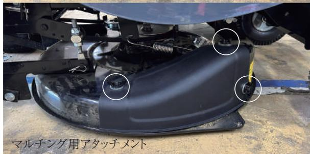
三箇所ある蝶ネジを緩め、アタッチメントを付け替えます。付け替えた後は、ワッシャー、蝶ネジの順でしっかりと締めてください。
