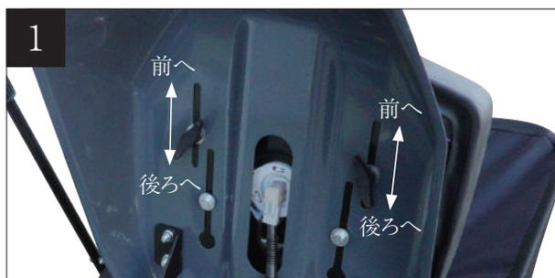
シート部分を開けステーで自立させ、ノブを緩めて身長に合わせてシート位置を上下させます。調整後はしっかりとノブを締めてください。
