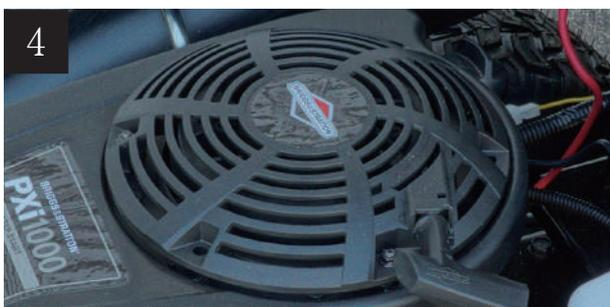
エンジンの空気吸入口に草などが堆積するとオーバーヒートや熱による車体の異常が発生する可能性があります。作業後には必ずエンジンの空気吸入口を点検し、草などが堆積している場合は取除いてください。
