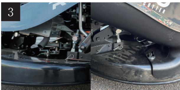
刈刃カバーに付いたりパイプに詰まった草・芝はそのまま放置しないで必ず毎回取除いてください。次回運転時にベルト負荷がかかり破損したり、摩擦で発火し火災の原因になります。
