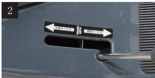
刈刃を駆動するには、刈刃回転制御レバーを「ブレード回転」の位置に合わせます。
