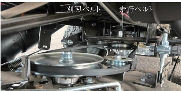
走行（駆動）ベルトと刈刃ベルトに切れや摩耗がないか確認し、不具合がある場合はベルトの交換を行います。
