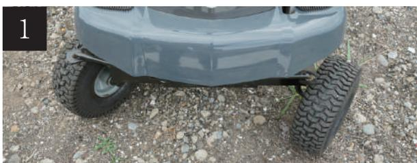
ハンドルを切った状態で発進しないでください。タイヤ、車軸、本体に負荷がかかり破損の原因になります。
