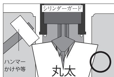
薪を割る際はエンジン始動後、2～3分後エンジンが安定し、暖まってきたのを確認したらスロットルを高速（←）にします。薪を割る際はスロットルは必ず高速（←）の状態で使用してください。低速の状態で薪割り作業を行うと力が半減してしまうばかりか故障の原因になる場合があります。
