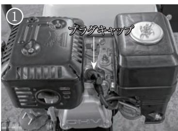
エンジンが正常に点火しない場合、もしくは使用 100 時間毎にプラグの清掃をおこなってください。プラグの汚れがひどい場合は新しいものと交換してください。
