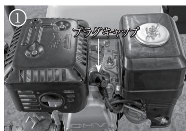
エンジンが正常に点火しない場合、もしくは使用 100 時間毎にプラグの清掃をおこなってください。プラグの汚れがひどい場合は新しいものと交換してください。
