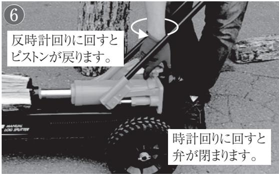
⑥ 薪が割れたら油圧解放弁を反時計回りに回して、ピストンとプッシュプレートを戻します。ピストンがシリンダー内に戻ったのを確認して油圧解放弁を閉めます。
