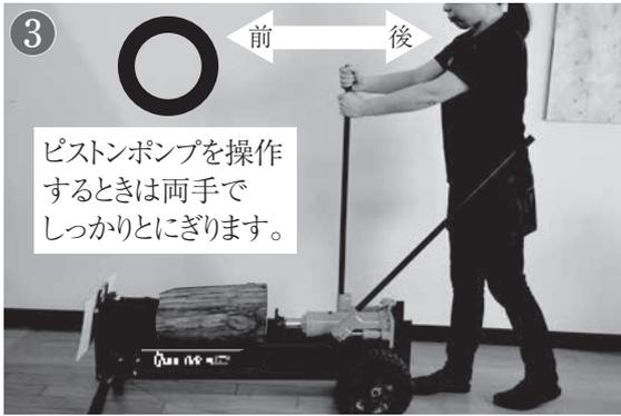
③ 写真のように薪をウェッジに合わせてセットし、操作ハンドルを両手で握ります。早送りピストンポンプで薪の所までプッシュプレートを送ります。
