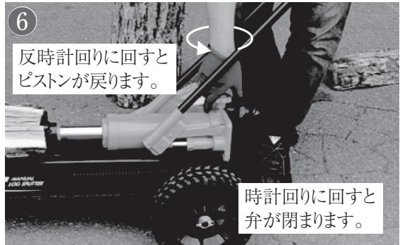
⑥ 薪が割れたら油圧解放弁を反時計回りに回して、ピストンとプッシュプレートを戻します。ピストンがシリンダー内に戻ったのを確認して油圧解放弁を閉めます。
