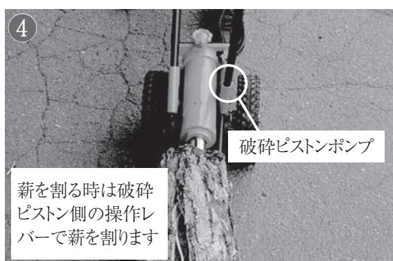
④プッシュプレートが薪にあたったら、今度は破碎ピストンポンプで薪を割っていきます。早送りピストンと交互に動かしても薪は割れません。破碎ピストン側のレバーを両手でしっかりと握り前後にポンプアップします。
