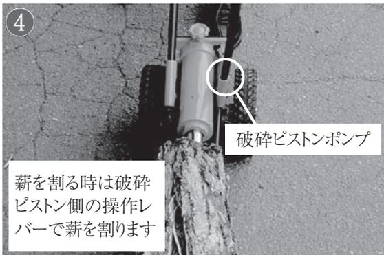
④ プッシュプレートが薪にあったら、今度は破碎ピストンポンプで薪を割っていきます。早送りピストンと交互に動かしても薪は割れません。破碎ピストン側のレバーを両手でしっかりと握り前後にポンプアップします。
