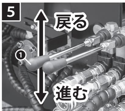
5 プロセッサに装備されているコントロールレバー①を操作することでプロセッサ本体に木材が移動する。
