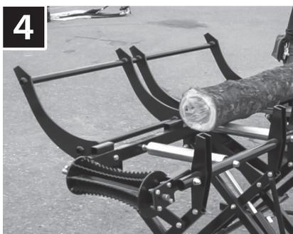
4 リフトアップの工程が終わると木材がローラーまで転がる構造。木材が落下しないようにウッドリフトはあげた状態にしておく。
