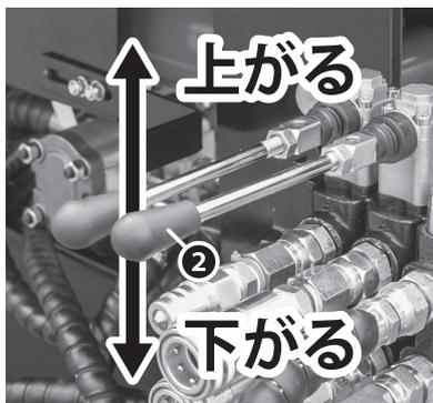
3 プロセッサ本体に取り付けたコントロールレバー②を操作することでウッドリフトが稼働し木材が持ち上がる。レバーを上げると木材が持ち上がり、レバーを下げると戻る構造。
