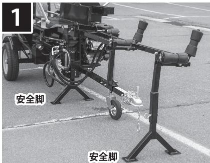
ロングログローダーを起動させる前に各部ボルトのゆるみがないか確認するのと、本機の安全脚が地面に設置しているか確認する。
