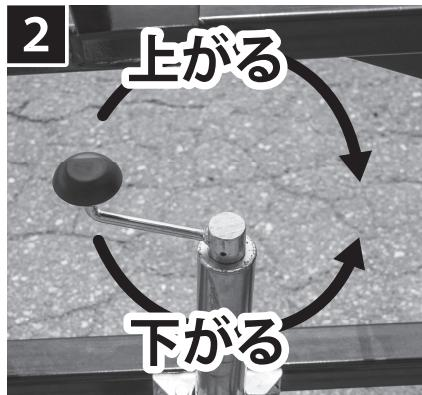
こちらもロングログローダーを起動させる前に本体の安全脚が地面にしっかりと設置しているか確認する。反時計回りで安全脚が地面に設置し、時計回りで浮きあがる。
