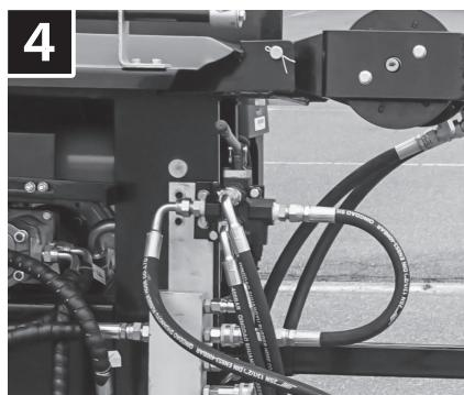
プロセッサー本体に取り付けたコントロールレバーを操作することでロングログローダーが稼働し木材が前進する。レバーを下げるとき材木が本体側に進み、レバーを上げると戻る構造。
