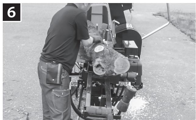
周囲の安全が確認できたらレバーを操作し木材をプロセッサー本体に移動させる。
