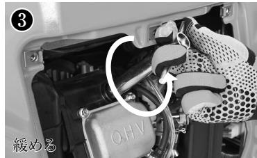
①メンテナンスカバーのネジを緩め、カバーを取り外します。
