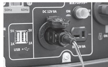
**！ 警 告** 充電中は絶対に喫煙、火気、火花、バッテリーの切断をしないでください。火花がバッテリーのガスを引火させる可能性があります。バッテリー充電中は爆発性の水素ガスが排出します。十分な換気を行ってください。
