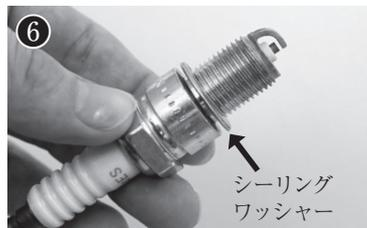
④ 点火プラグを点検し、電極の摩耗や絶縁体に亀裂、欠け、汚れがある場合は交換します。
