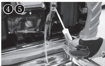
④ ドレインスクリューを反時計回りに緩め、ドレインホースから容器にガソリンを排出します。
