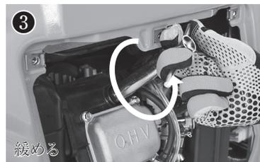
① メンテナンスカバーのネジを緩め、カバーを取り外します。
