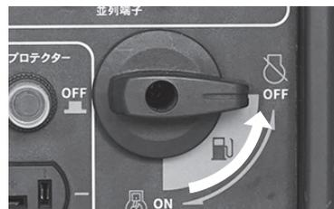
① 本機の交流コンセントに接続されている使用機器を全て停止し、コンセントを外します。
