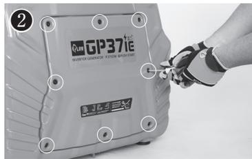
② メンテナンスカバーのネジを緩め、カバーを取り外します。
