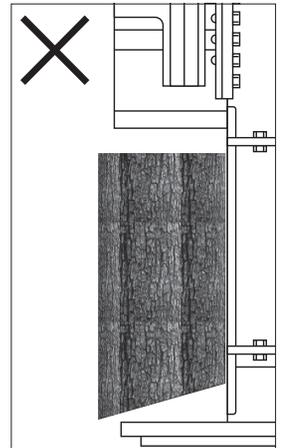
GLS30は縦型と横型の2タイプの変形が可能です。軽トラックなど荷台においてある薪や長時間使用する場合は横型での使用、地面においてある大きな丸太を割る際は縦型など用途に合わせてご使用方法をお選びください。
