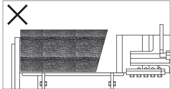
■縦型時の丸太の置き方(薪対応長さ61cmまで)
