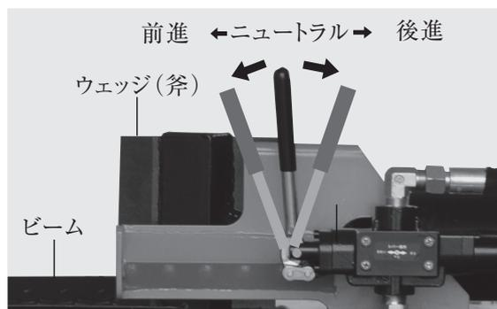
① コントロールレバーを左側（ビーム側）に倒し続けるとウェッジ（斧）が左側に前進します。
