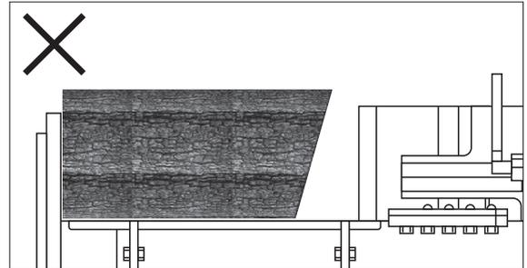
■縦型時の丸太の置き方 (薪対応長さ61cmまで)
