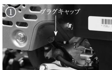
エンジンの点火が正常に始動しない場合、もしくは使用 100 時間毎にプラグの清掃を行ってください。プラグの汚れがひどい場合は新しものと交換してください。
