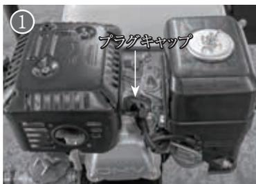
エンジンの点火が正常に始動しない場合、もしくは使用 100 時間毎にプラグの清掃を行ってください。プラグの汚れがひどい場合は新しいものと交換してください。
