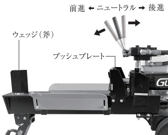
①コントロールレバーを前（ウェッジ側）に倒し続けるとプッシュプレートが前進します。
