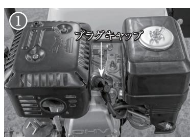
エンジンの点火が正常に始動しない場合、もしくは使用 100 時間毎にプラグの清掃を行ってください。プラグの汚れがひどい場合は新しものと交換してください。
