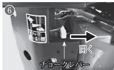
**！ 注意** エンジン停止直後や気温が高い場合、チョークを閉じるとガソリン供給過多によりエンジンがかからない場合があります。その場合はチョークレバーを開けてリコイルを引いてください。また、エンジンがかからずにリコイルを何度も引いてしまうとプラグにガソリンが被り火花が飛ばない状態になる場合があります。その場合は少し時間を置き、再度始動してください。
