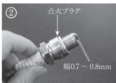
エンジンの点火が正常に始動しない場合、もしくは使用 50 時間毎にプラグの清掃を行ってください。プラグの汚れがひどい場合は新しものと交換してください。
