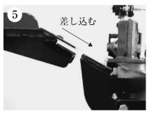
サイドテーブルには裏面の台座と の間に隙間があります。その隙間 にベースを差し込みます。
