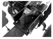
左右3本ずつ、計6本のボルトを 締め付ければ、シリンダーガード の完成です。
