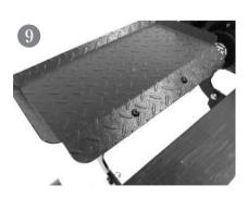
最後に、再度ボルトのゆるみがないか確認し、増し締めをすれば、 サイドテーブルの取付は完了です。
