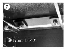
六角穴付ボタンボルトの下側に付属のナイロンロックナットを軽く手で締め付け、17mmのレンチで押さえます。
