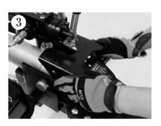
両面のボルトを取り外せたら既存 のシリンダーガードを取り外しま す。
