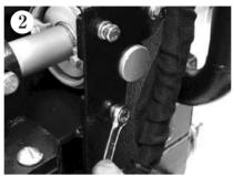
13mmのレンチを使い、片面3本 づつ、計6本のボルトを外します。 この時、油圧ホースや取り付け部 などを破損しないようご注意くだ さいっ
