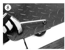
供回りしないように下のナットを レンチで抑えながら、6mm 六角 レンチで六角穴付ボタンボルトを 締めつけます。
