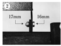
取り付け部のボルトとナットを取り外します。ナットは17mm、ボルトは16mmのレンチを使用します。
