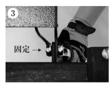
供回りしないよう、17mmのレンチでナットを固定し、ボルトを反時計回りに回します。取り外したボルトとナットは新しく取り付ける取付ベースに再利用します。
