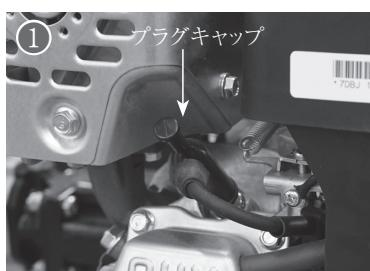
エンジンの点火が正常に始動しない場合、もしくは使用 100 時間毎にプラグの清掃を行ってください。プラグの汚れがひどい場合は新しものと交換してください。
