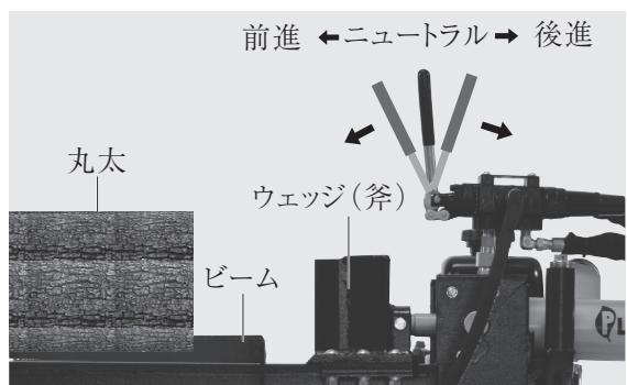
①コントロールレバーを前（ウェッジ側）に倒し続けるとプッシュプレートが前進します。
