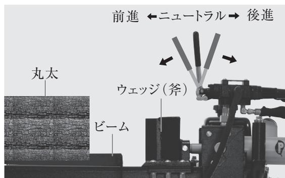
① コントロールレバーを前（ウェッジ側）に倒し続けるとプッシュプレートが前進します。
