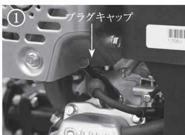
エンジンの点火が正常に始動しない場合、もしくは使用 100 時間毎にプラグの清掃を行ってください。プラグの汚れがひどい場合は新しいものと交換してください。
