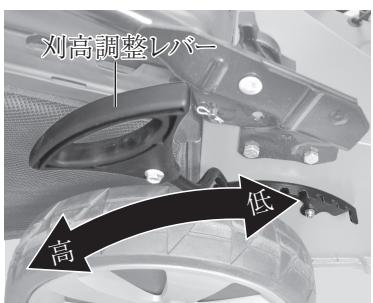
刈高の調整は 20 ~ 80 mmまでの8段階調整が可能です。高さの目安は芝や土壌の条件によって異なります。切断面の高さを調整する時は必ずエンジンを停止させてください。高さの目安がわからない場合は必ず一番高い設定から段階的に下げ刈高を設定してください。日本の芝は通常 30mm が一般的な長さです。
