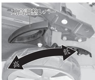
刈高の調整は 20 ~ 80 mmまでの8段階調整が可能です。高さの目安は芝や土壤の条件によって異なります。切断面の高さを調整する時は必ずエンジンを停止させてください。高さの目安がわからない場合は必ず一番高い設定から段階的に下げ刈高を設定してください。日本の芝は通常 30mm が一般的な長さです。
