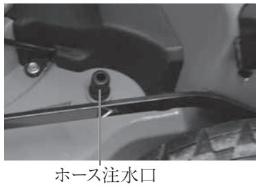
ホース注水口に水道ホースを接続し、エンジンを始動しブレードを回転させることで、ブレードとデッキ内部を洗浄することができます。芝の刈り取り後の洗浄メンテナンスとしてご使用ください。
