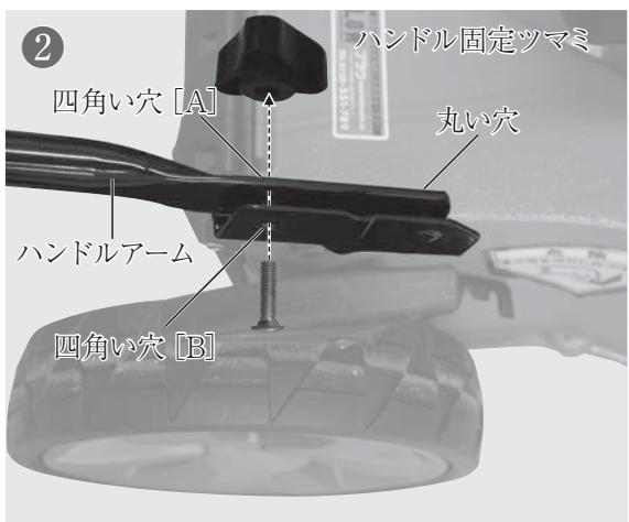
②ハンドル取付ベースの四角い穴 [B] とハンドルアームの四角い穴 [A] の重なった穴に、外側から固定ボルトを差し込みます。このとき、固定ボルトの四角い根元部分までしっかりとはまっていることを確認し、ハンドル固定ツマミを取り付けます。
