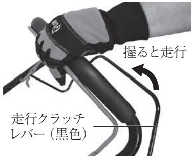
刈刃クラッチレバーを握ったまま走行クラッチレバーを握る事で自走します。早歩き程度の速度で走行しますが、ゆっくり作業されたい場合は走行クラッチレバーを放し手押しで任意の歩行速度での作業をお勧め致します。
