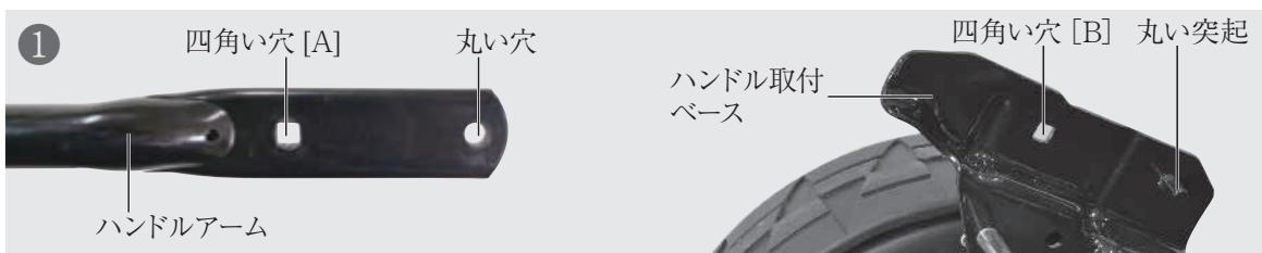
①芝刈り機本体の左右のアームベースの丸い突起に、ハンドルアームの左右の先端部分の丸い穴をはめ込みます。（※変形しない程度に左右のアームの先端の間隔を狭めるようにして取り付けます。）
