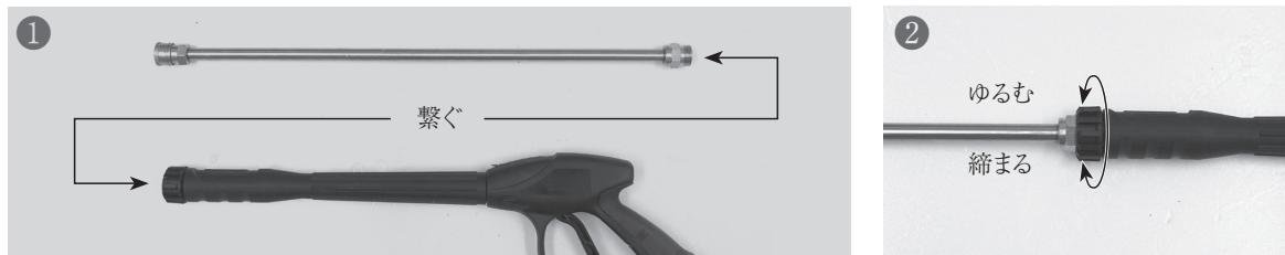
①開封時分割されているガンノズル（⑤）とガンハンドル（⑩）を組み立てます。
