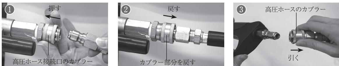
①高压ホース接続口についているカプラーを本体側に押し込み、高压ホースの雄口側を取り付けます。
