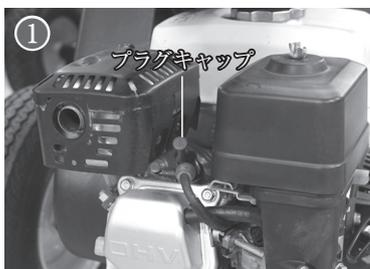
プラグが正常に点火しない場合、もしくは使用 100 時間毎にプラグの清掃を行ってください。プラグの汚れがひどい場合は新しいものと交換してください。
