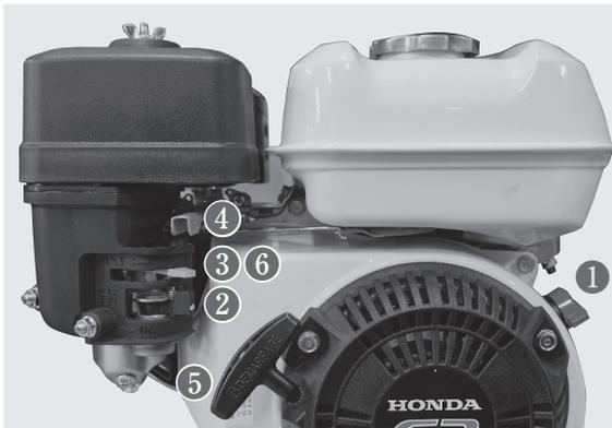
エンジン始動の前に必ず適量のエンジンオイルと、購入してから1か月以内の新鮮なガソリンが充填されていることを確認してください。(購入後、何カ月も経過した燃料は燃焼不良によりエンジンに不具合を引き起こす恐れがあります。)
