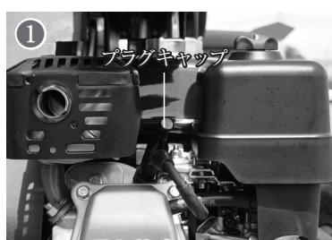
プラグが正常に点火しない場合、もしくは使用 100 時間毎にプラグの清掃を行ってください。プラグの汚れがひどい場合は新しいものと交換してください。
