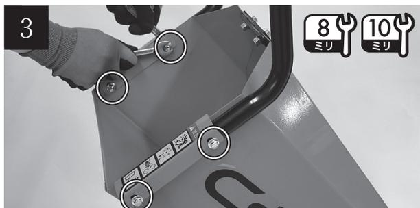
付属のハンドル取付ボルトを外側から挿し込みます。投入口（ホッパー）内側からナットで固定します。4カ所とも、ボルトでしっかり固定してください。
