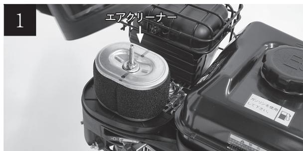
エアクリーナーカバーの上の蝶ネジを反時計方向に回し、カバーを取り外します。
