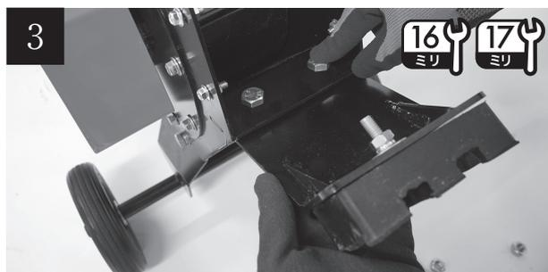
本機側の取付穴の下側へフロントレッグスタンド側の取付穴を合わせ、一旦外したボルトを上側から挿し込みます。下側からワッシャー、スプリングワッシャー、ナットの順番でボルトに通し、ナットを回して固定します。
