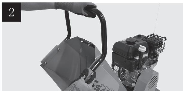
投入口（ホッパー）側面の取付穴各2カ所と、ハンドルの穴位置を合わせます。ハンドルおさえを取付穴の位置にあわせて上から重ねます。
