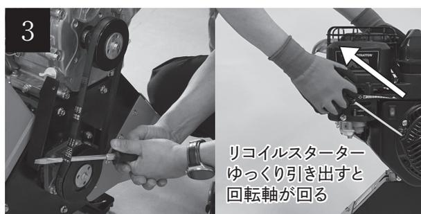
1 人の作業員がベルトにマイナスドライバーを横から差し入れ、2 人目の作業員がリコイルロープをゆっくり引き出します。マイナスドライバーをテコにし、プーリーからベルトを取り外してください。
