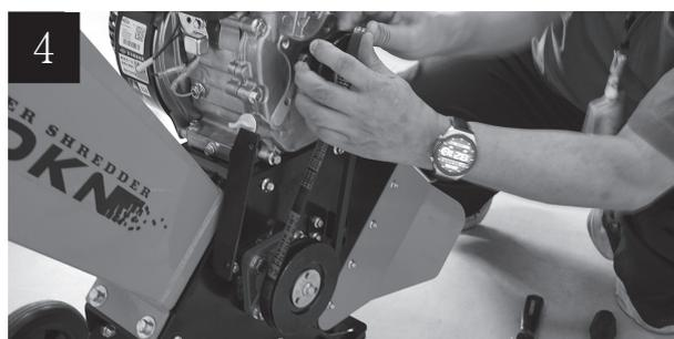
新しいベルトを、下部のプーリー下からレールに掛け、上のプーリーレールにかぶせるように取付けます。
