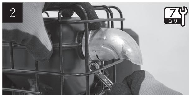
マフラーカッターを排気口に装着し、ボルトを本締めして固定します。
