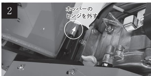
本体の投入口（ホッパー）取り付け位置のヒンジ（オス）から投入口（ホッパー）のヒンジ（メス）を横にスライドするように動かして取り外します。
