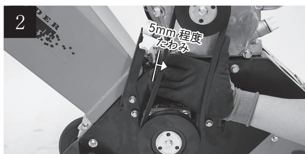
ベルトに亀裂や摩耗、損傷がないか確認します。ベルトを指で押さえ、5mm程度のたわみを確かめます。たわみが大きい場合はベルトの交換が必要です。
