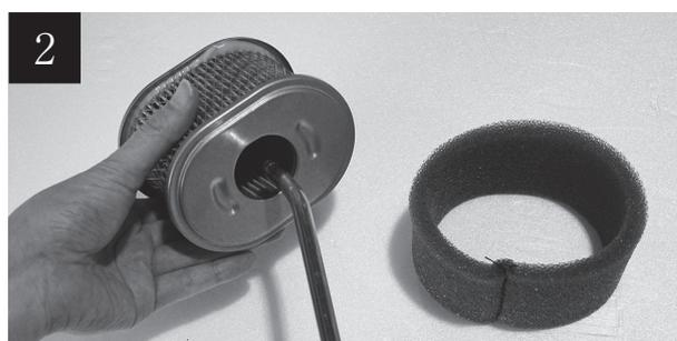
中のエアクリーナーを取り外し、内側からエアアなどで吹いてゴミを取り除きます。外側のスポンジ部分は中性洗剤で良く洗い、よく乾かして取り付けてください。汚れがひどい時や、スポンジが劣化している時は新しいものに交換をしてください。
