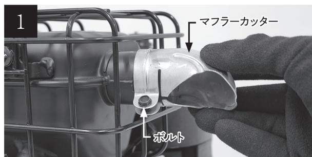
付属のエンジン部マフラーカッターの固定穴にボルトを仮留めします。市販の7mmレンチを使用してください。
