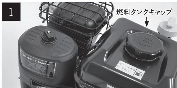
本機を水平な状態で置いてください。燃料タンクのキャップを取り外します。タンク内の燃料を手動ポンプなどで抜き取ります。
