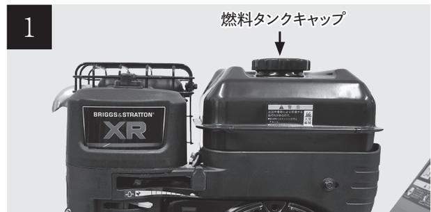
燃料タンクキャップを外し、液面を見て残量を確認します。
