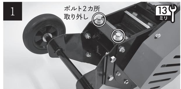
本体の投入口(ホッパー) 取り付け位置に仮止めしているボルト、ワッシャーを13mmレンチで取り外します。
