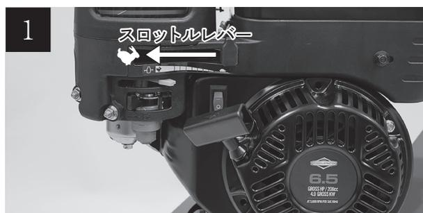
エンジンを始動し、回転が安定しているか確認します。スロットルレバーは「高速 高速アイコン (←)」の位置になっているかを確認します。
