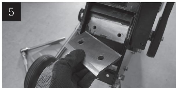
ボルトを取り外し、刃を取り出します。刃は鋭いため、気をつけて取り出してください。
