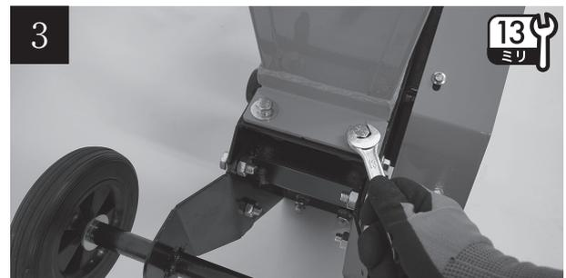
一旦外したボルトに、スプリングワッシャーとワッシャーを通し、本体取付穴に挿し込み、ボルトを13mmレンチで固定します。
