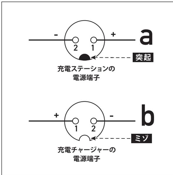
1. 充電チャージャーの電源端子 b と充電ステーションの電源端子 a を接続します。プラグ a の 1 とプラグ b の 1 を接続し、しっかりとねじ込みをしてください。
